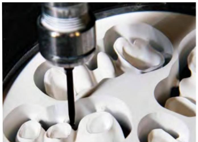
**FIGURA 8** - Vista aproximada da parte ativa da máquina Neoshape realizando uma fresagem em uma bolacha em zircônia tetragonal estabilizada por ítrio.
