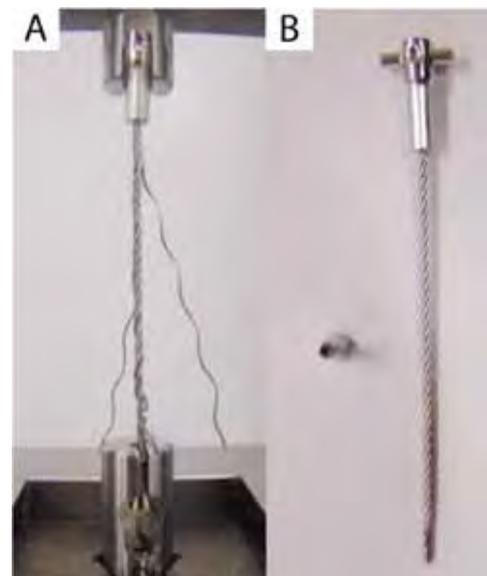
Figura 7. Exemplos de falhas encontrados após a realização dos testes de tração.
