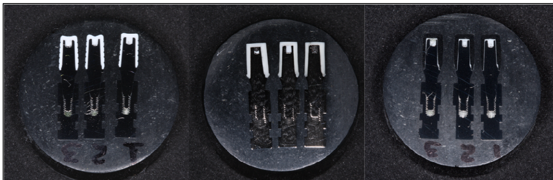
Figura 10: Amostras embutidas com polimento final para serem analisadas (cilindro calcinável, cilindro de alumina e copings metálicos).
