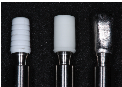
Figura 3: Cilindro Calcinável, Cilindro de Alumina e Coping obtido após a fundição.
