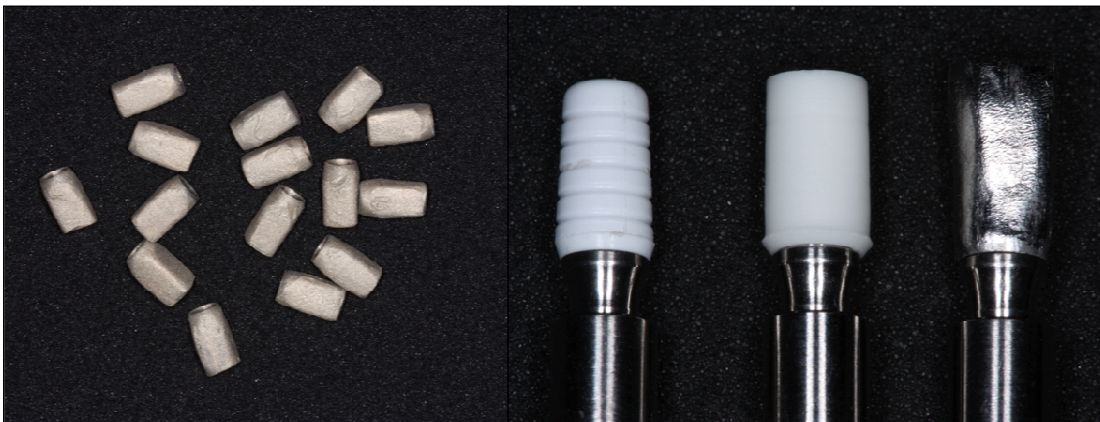
Figura 5: Copings metálicos obtidos após a fundição e cilindros Calcinável, Alumina e coping fundido.
