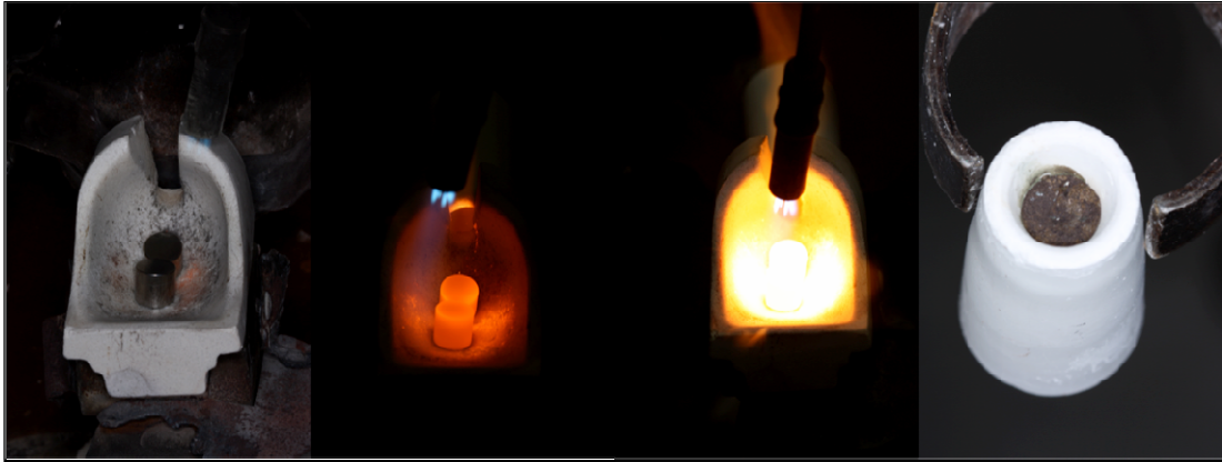
Figura 4: Seqüência do processo de fundição.
