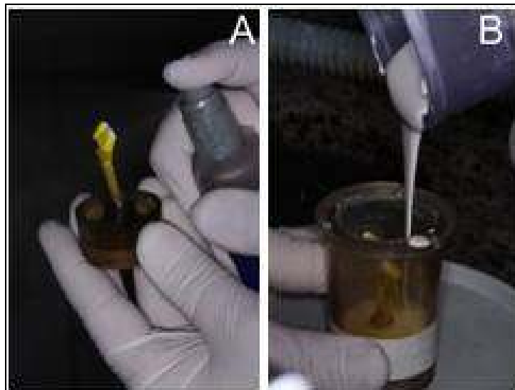
Figura 3: Inclusão do padrão para fundição, A. aplicação do antibolha; B. Preenchimento do anel com revestimento.
