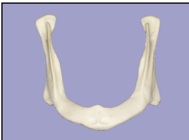
Figura 1 – Mandíbula de poliuretano intacta com 6 mm de altura
