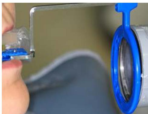
Figura 6 – Aspecto do posicionador radiográfico em posição para a tomada.
