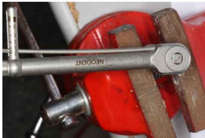
Figura 6 – Torque de 15N no pilar com parafuso passante.
