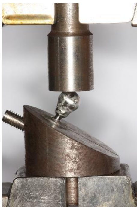
Figura 5 – Conjunto do ensaio fixado em dispositivo para teste com angulação de 30°.
