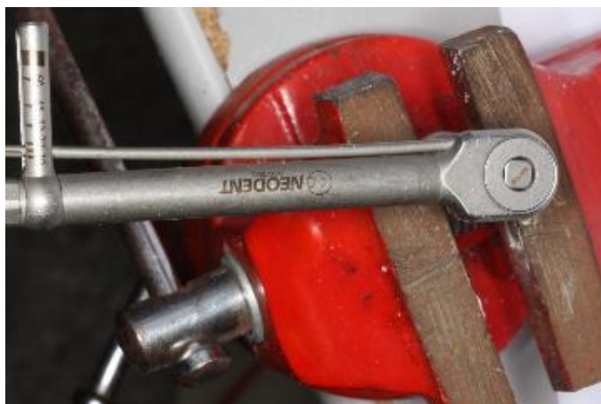
Figura 3 – Torque de 15N no pilar com parafuso passante.
