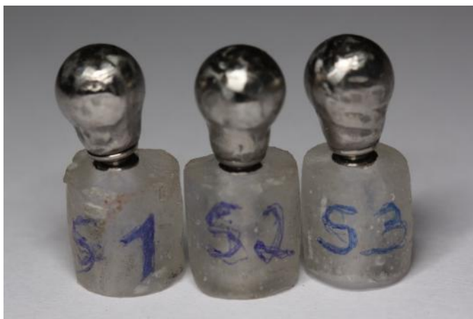
Figura 1 – Corpos de prova com: Análogos, munhões sólidos com 1,5mm de transmucoso e esfera em níquel-cromo.
