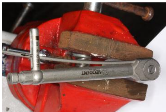
Figura 2 – Torque de 32N no pilar sólido.
