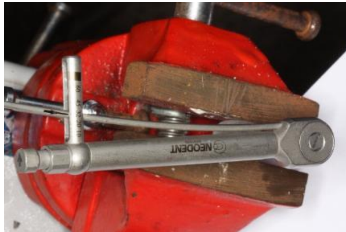
Figura 5 – Torque de 32N no pilar sólido.
