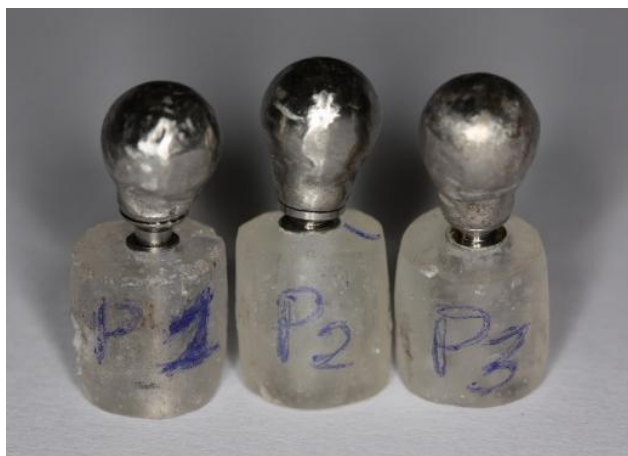
Figura 2 – Corpos de prova com: Análogos, munhões com parafuso passante com 1,5mm de transverso e esfera em níquel-cromo.
