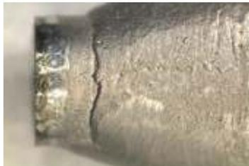
Figura 7 - Visão externa da borda do cilindro de CoCr soldado ao padrão fundido em CoCr.
