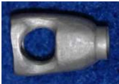
Figura 3 - Padrão fundido em CoCr.
