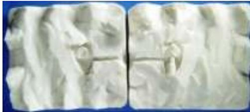
Figura 8 - Molde proveniente da remoção do padrão original.
