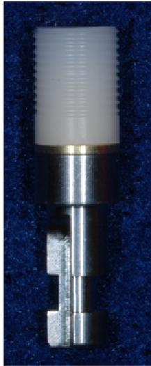
Figura 2 - Cilindro calcinável sobre o de latão.
