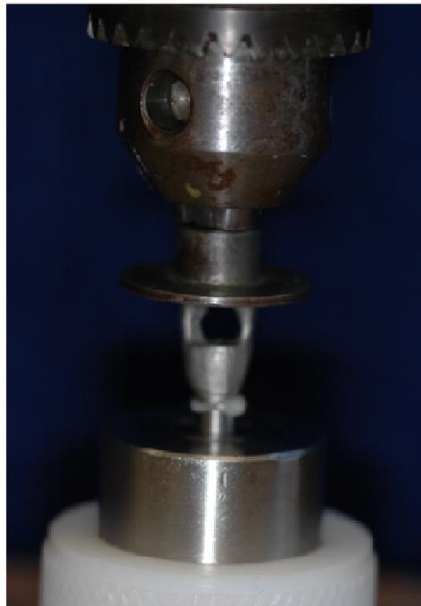
Figura 19 - Dispositivo de pressão constante para cimentação.
