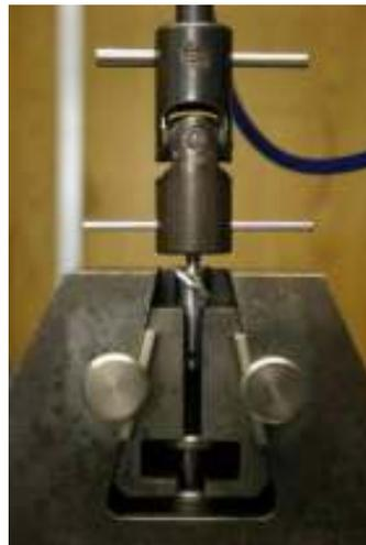
Figura 8 – Amostra posicionada para o ensaio de tração
