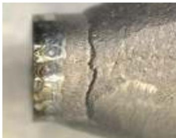
Figura 20 - Solda no cilindro de Cobalto-Cromo.
