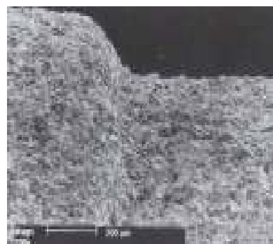
Figuras 1 e 2 Texturização de superfície por adição realizado com partículas de titânio (Plasma Spray de Titânio)
