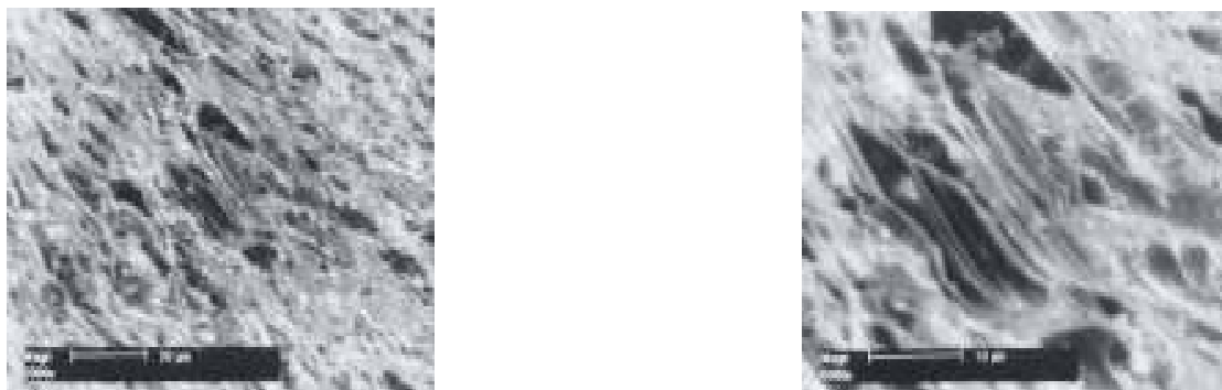
Figuras 5 e 6 Macrotextrização superficial por subtração ( jateamento com partículas de vários diâmetros )
