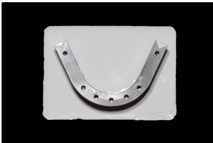
Figura 15 – Modelo obtido após o vazamento.
