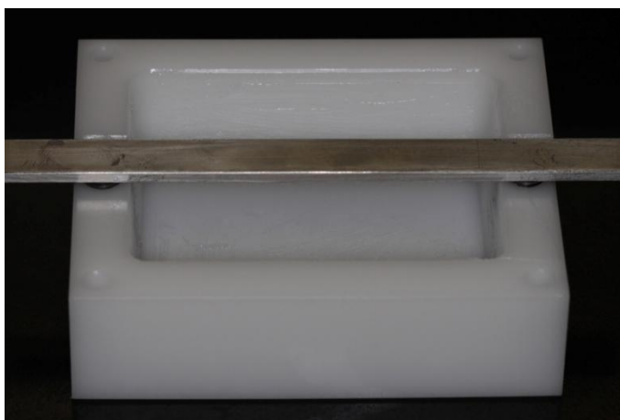
Figura 14 – Barra utilizada para garantir o nivelamento e a padronização de posição.
