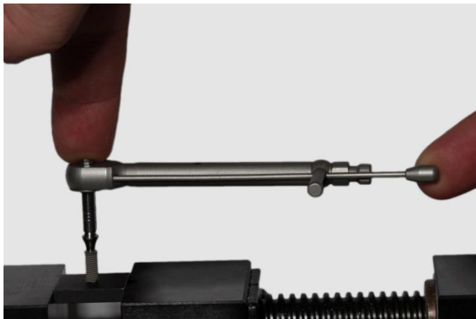
Figura 11 – Torque sendo aplicado ao pilar na base de apoio.
