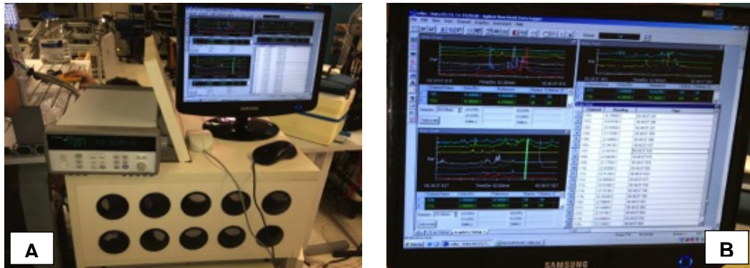
Figura 47 – A, Equipamento e módulo Agilent ® para leituras dos dados térmicos; B – Detalhes dos gráficos com registros de tempos e temperaturas.
