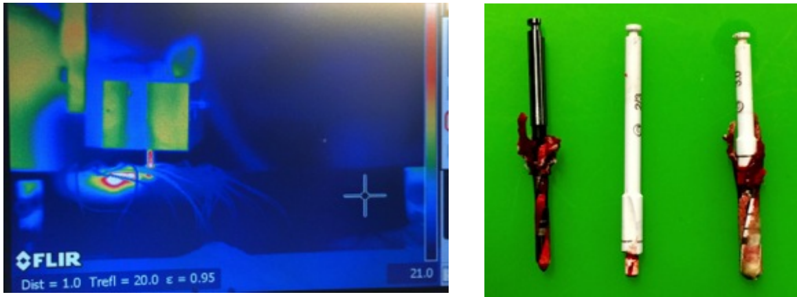
Figura 3 - Aquecimento da broca e da superfície óssea registrados na câmera IV.
