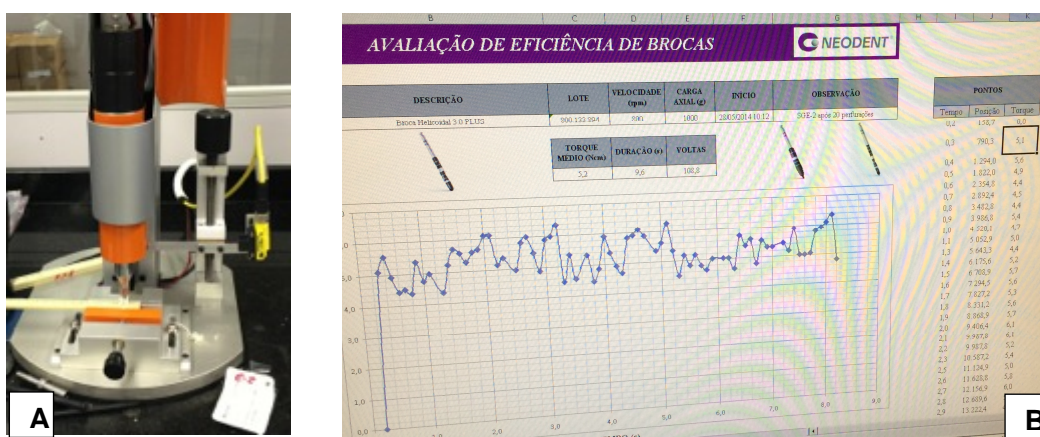
Figura 23 – A, Equipamento para o teste de EC; B - Programa para avaliação de eficiência de brocas ou eficiência de corte (Neodent).
