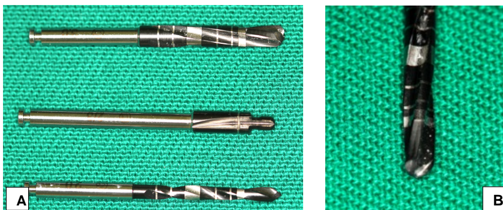
Figura 8 – A, Brocas de aço com revestimento DLC. B - Detalhes da broca \varnothing 3,0\text{mm} .
