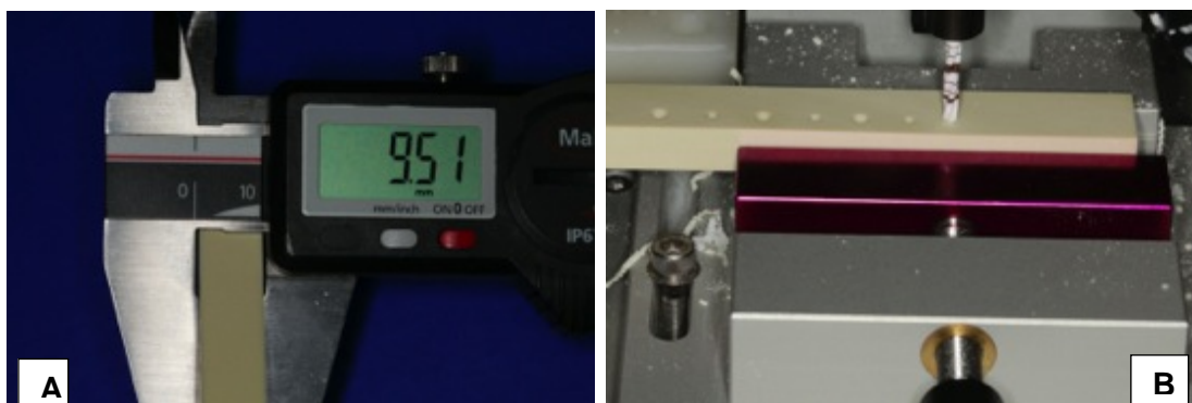
Figura 22– A, Material poliuretano para testes de EC; B- Furação do blank padrão (EC1).
