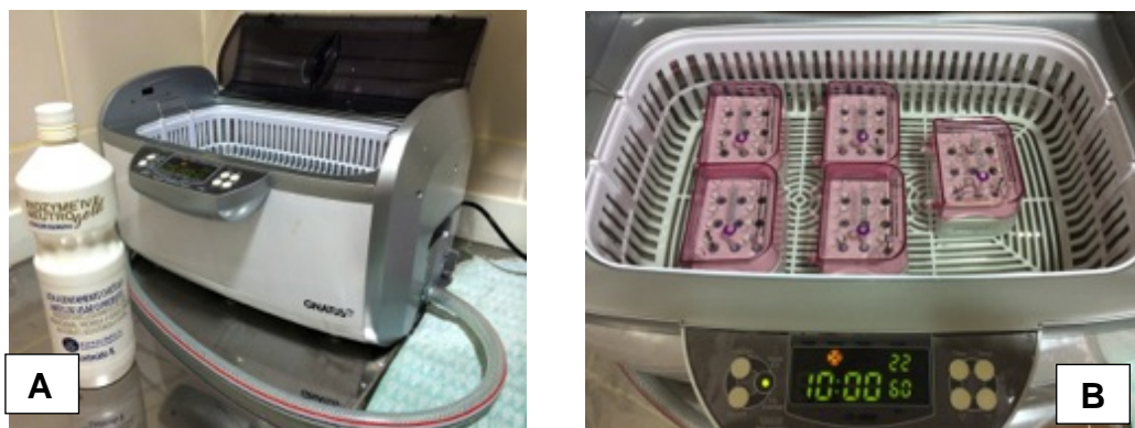
Figura 46– A, Cuba ultrassônica e detergente enzimático utilizado; B - Processo de limpeza das brocas por SG de materiais, antes da pesagem para testes de PM.
