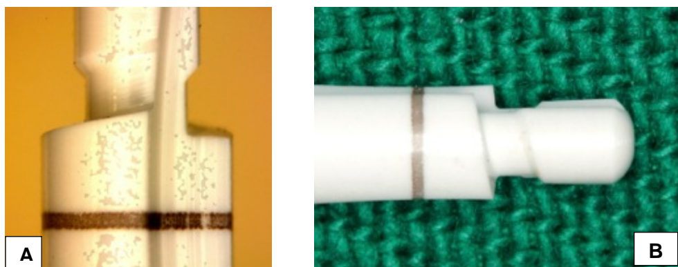
Figura 18 – A, Lâminas de corte da broca piloto cerâmica. B - Vista lateral da broca com uma guia apical de 3mm e corte efetivo de 2mm até a marca a laser.
