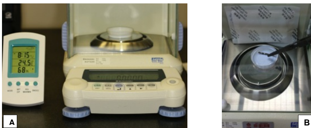
Figura 24– A, Balança analítica de precisão; B - Broca no processo de pesagem inicial.
