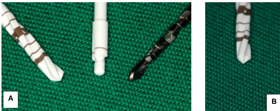
Figura 10 – A, Brocas do grupo GZ(misto). B - Detalhes da cerâmica ATZ Ø3,0mm.
