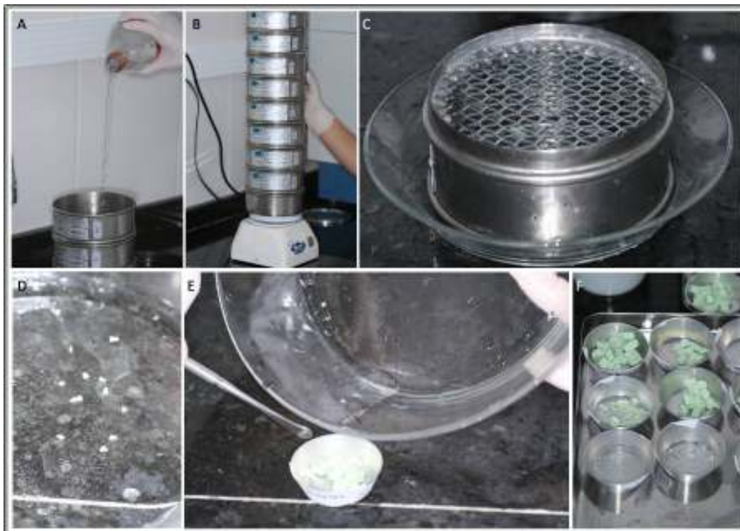
Figura 7 – A. 1000ml de água despejados sobre as peneiras; B. Peneiras posicionadas sobre o vibrador; C, D. Coleta das partículas em prato de vidro; E, F. Acondicionamento das partículas em recipientes de alumínio.
