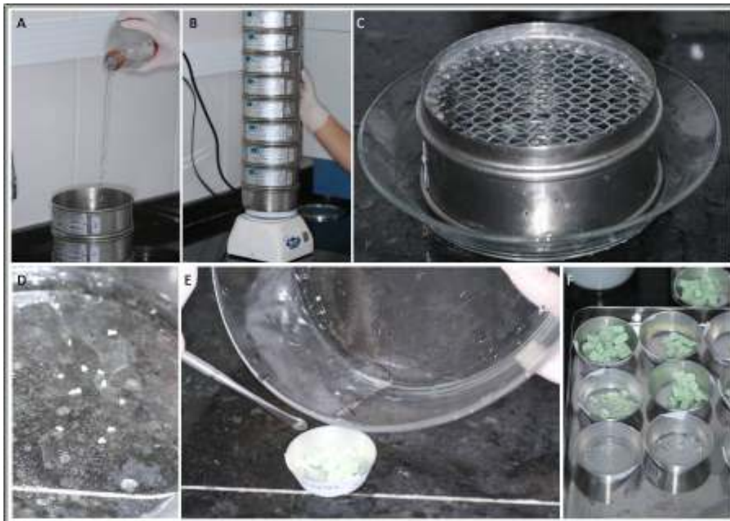
Figura 6 – Método utilizado para tamisar: A. 1000ml de água despejados sobre as peneiras; B. Peneiras posicionadas sobre o vibrador; C, D. Coleta das partículas em prato de vidro; E, F. Acondicionamento das partículas em recipientes de alumínio.
