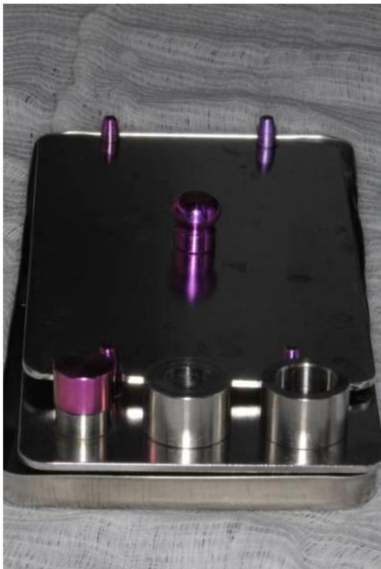
Figura 8: Kit para a obtenção das membranas
