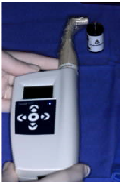
Figura 21 - Calibração do aparelho Osstell™ Mentor antes de iniciar as medições.
