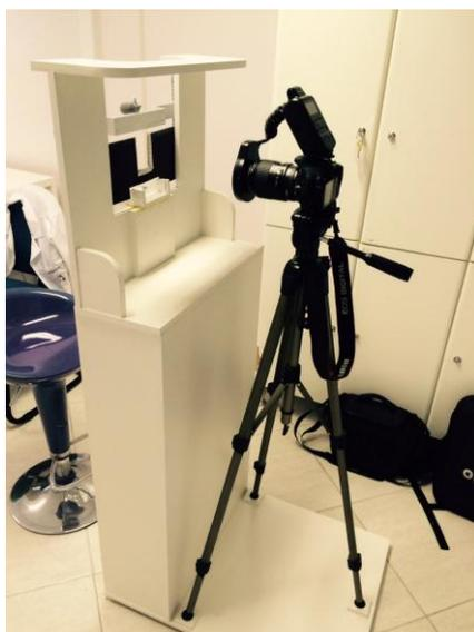
Figura-1. Estrutura para padronizar fotografias com a máquina posicionada no tripé.
