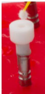
Figura 5 (remoção do excesso de cimento)
