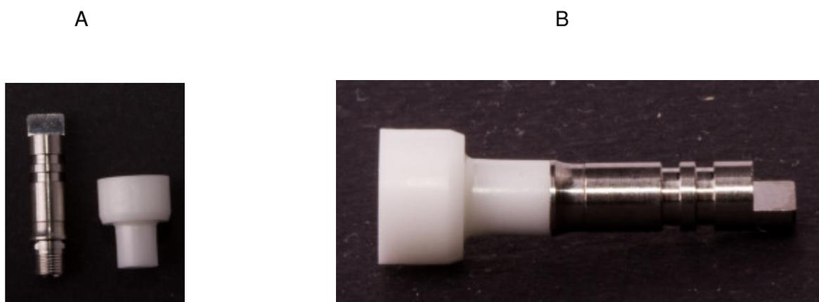
Figura 2 A (análogo/base em Ti e *coping* Zr) B (análogo/base em Ti e *coping* Zr)
