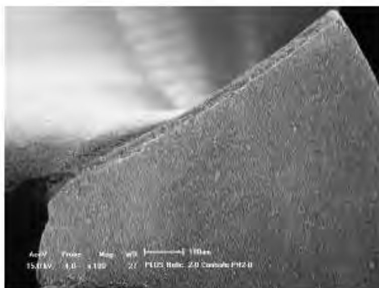
Figura 10 – Microscopias da broca Helicoidal (Ø2,0mm) em Aço com Revestimento (0 perfurações). Aumentos de (a)50 e (b)100x.
