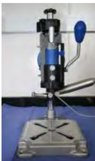
Figura 3 – Braço mecânico com contra-ângulo acoplado.
