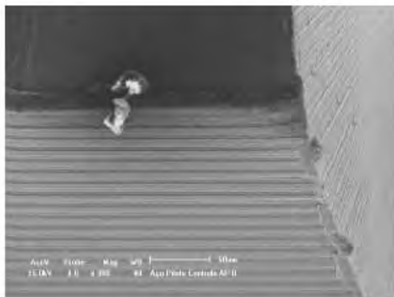
Figura 13 - Microscopias da broca Piloto em Aço (Ø perfurações). Aumentos de (a)30 e (b)300x.
