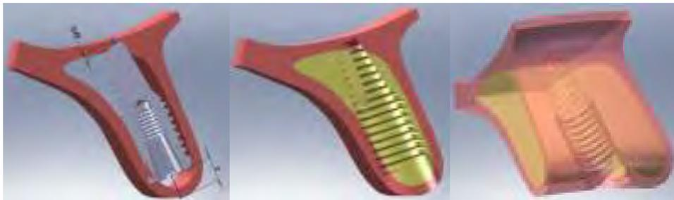
Figura 11: Vistas em corte do modelo do implante inserido no modelo ósseo.
