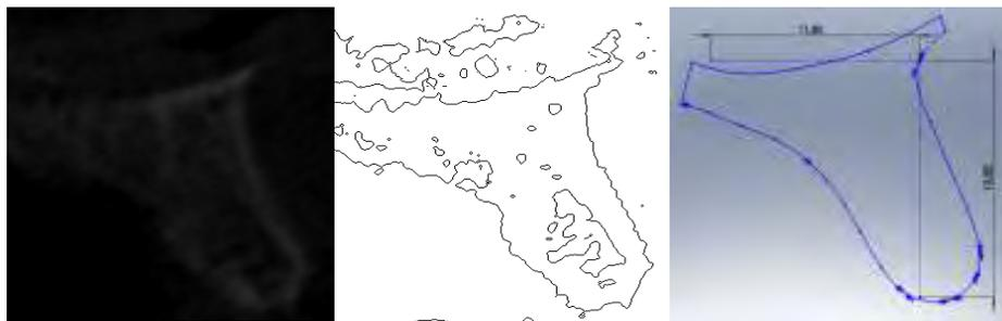
Figura 5: Fases do processamento da imagem da tomografia computadorizada.
