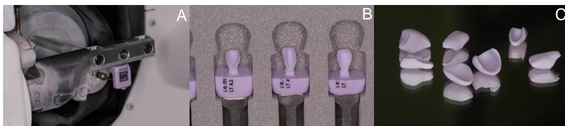
Figura 25: Usinagem dos blocos IPS e.max CAD A. Ceramill Motion 2 B. Blocos usinados C. Facetas recortadas e prontas para acabamento
