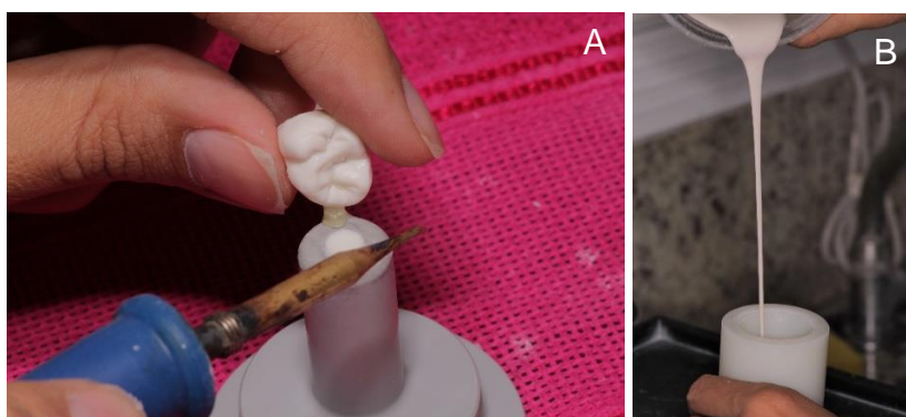
Figura 10: A. Posicionamento dos elementos encerados no anel de injeção B. Material de revestimento
