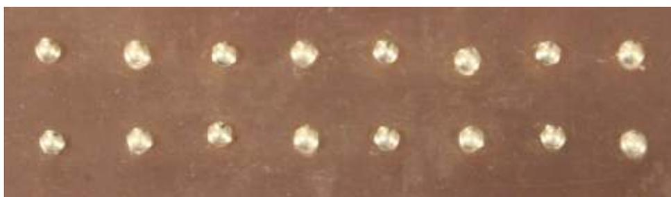
Figura 4 – Mini-implantes dispostos lado a lado com espaço de 1,0cm entre eles.
