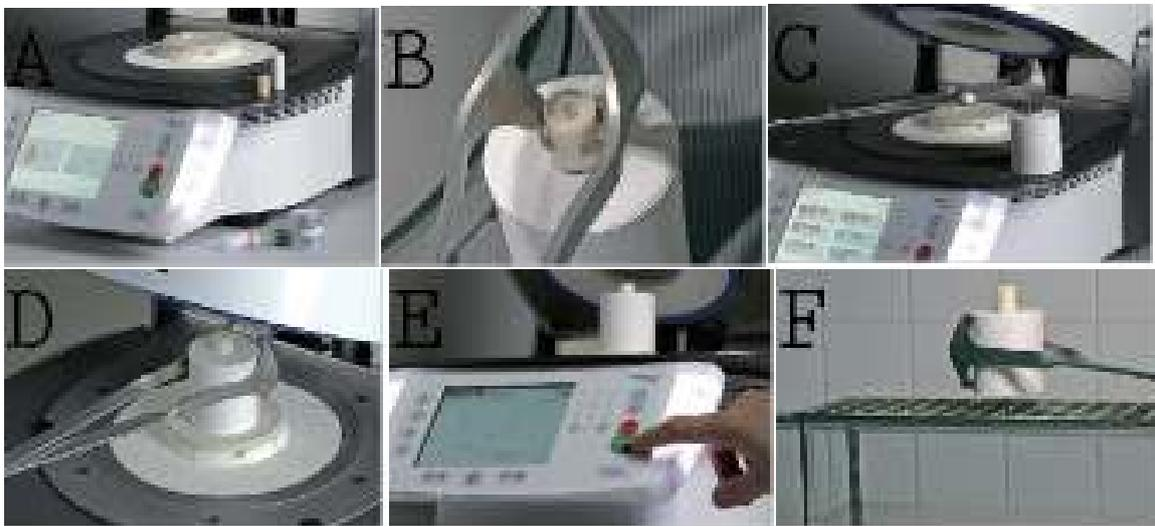
Figura 8 – Visualização (figuras A-F) da injeção da pastilha de porcelana por meio de um forno especial. (Ivoclar Vivadent, [www.ivoclarvivadent.com.br](http://www.ivoclarvivadent.com.br)).
