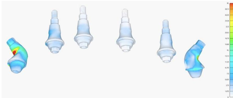
Figura 20- Distribuição das tensões de von Mises sobre os mini pilares retos e angulados de 45°, grupo 2.
