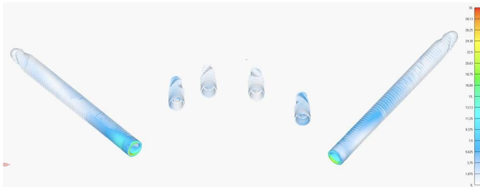
Figura 18- Imagem da distribuição das tensões de von Mises sobre os implantes para o grupo 2.
