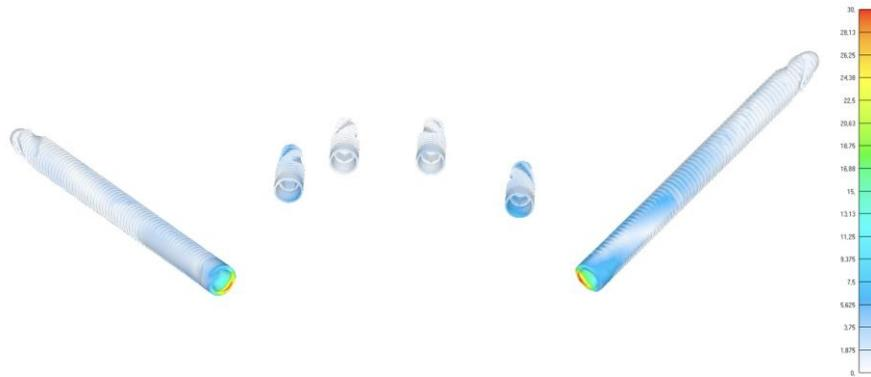
Figura 17- Imagem da distribuição das tensões de von Mises sobre os implantes para o grupo 1.
