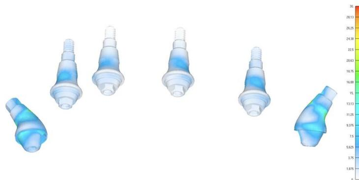
Figura 19- Distribuição das tensões de Von Mises sobre os mini pilares retos e angulados de 30°, grupo 1.
