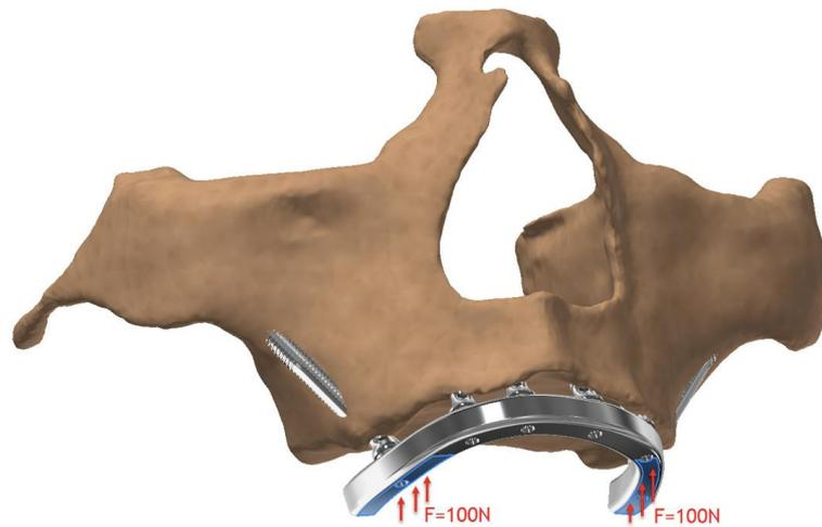
Figura 10- Observar região de incidência e força da carga oclusal sobre a infra estrutura metálica instalada no modelo, a carga considerada foi de 100N aplicada perpendicularmente à barra.
