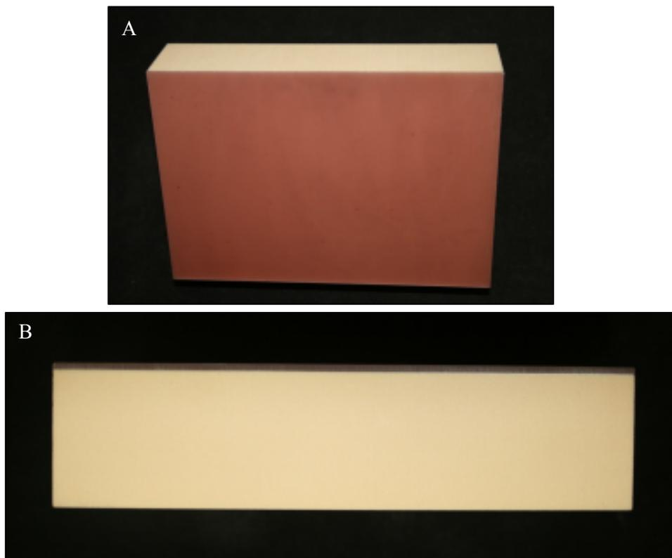
Figura 1: (A) Bloco de osso sintético laminado (170x120x42mm). (B) Bloco de osso sintético laminado, evidenciando a espessura menor representando a cortical e a maior representando a medular.
