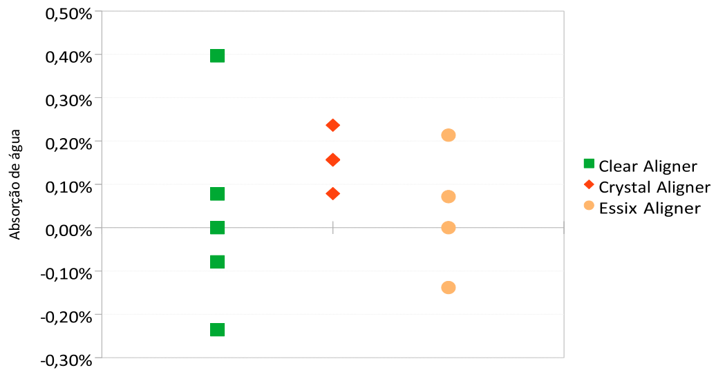
Figura 9 – Dados individuais de absorção de água para os corpos de prova das três marcas analisadas.
