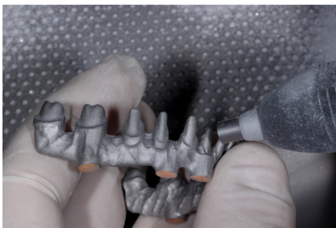
Figura 13 – Jateamento das estruturas.
