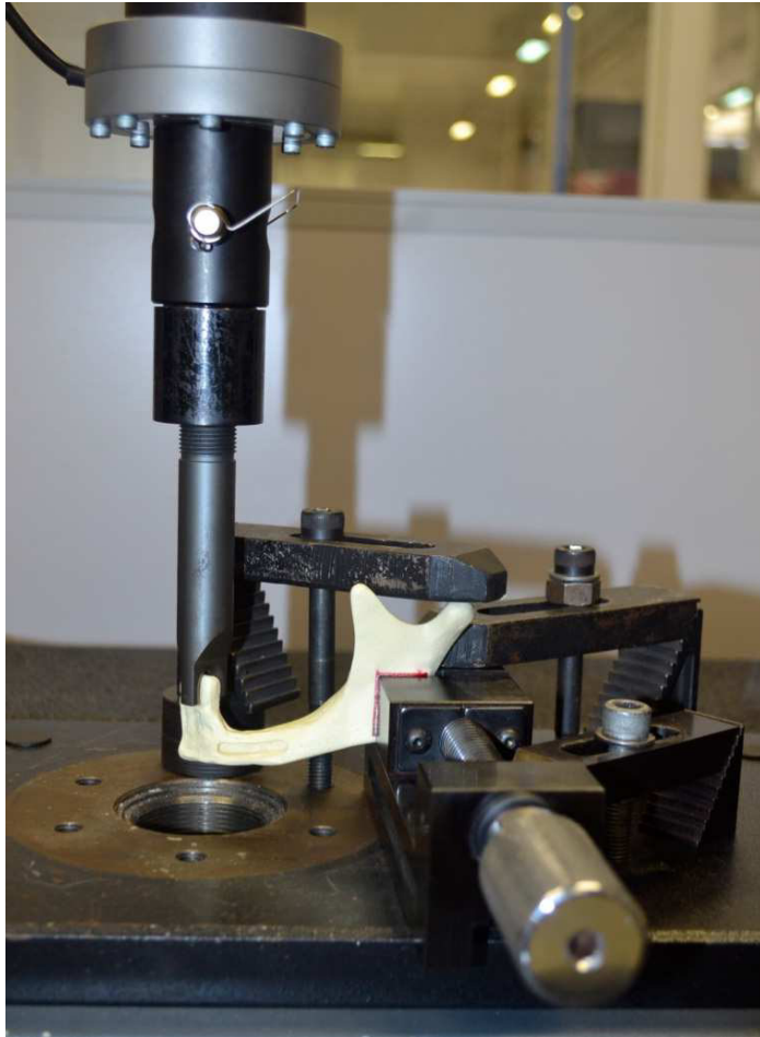
Figura 9 – Hemimandíbula submetida a força linear na região anterior para a aplicação de carga progressiva, até a obtenção do valor de resistência ao carregamento.
