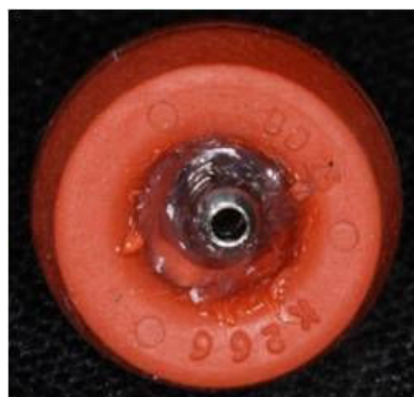
Figura 4 - Detalhe da perfuração do ápice do implante na tampa do tubo de ensaio.
