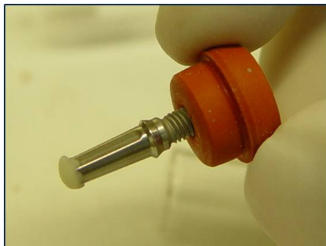
Figura 5 - Conjunto implante/pilar inserido na tampa do tubo de ensaio.
