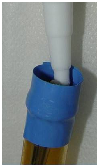
Figura 7 – Aplicação de adesivo silicone.
