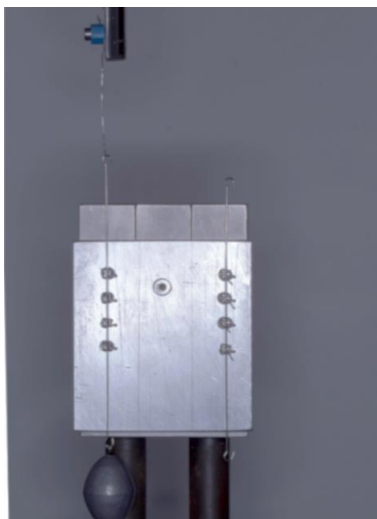
Figura 3 – Placa de leitura, com peso de 50g na extremidade inferior do fio – ensaio 2.
