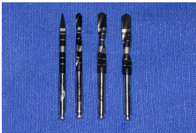
Figura 11 - Brocas com tratamento de superfície com aplicação de filme de carboneto de tungstênio com matriz de carbono (WC/C).
