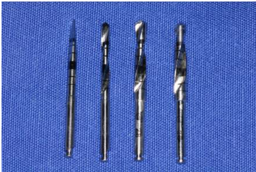
Figura 1 - Brocas com tratamento superficial de passivação.
