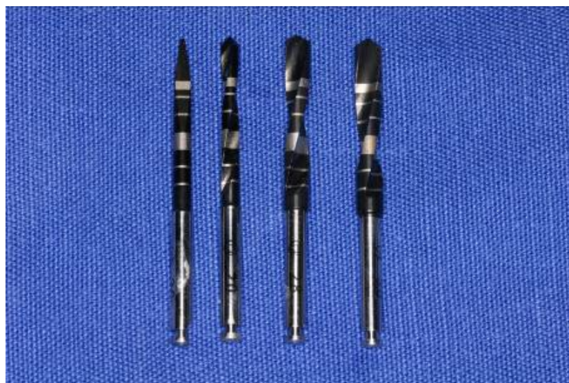
Figura 2 - Brocas com tratamento de superfície com aplicação de filme de carboneto de tungstênio com matriz de carbono (WC/C).
