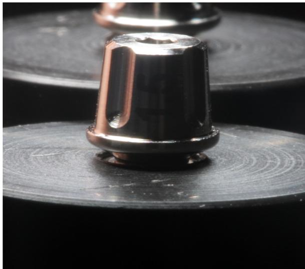
Figura 2- Componente Protético: Munhão Universal CM (Neodent), altura Cinta 1,5mm; altura Coronária 4 mm; diâmetro 4.5. Instalado em implante Titamax Cortical CM (Neodent) inseridos em bloco de poliacetal simulando o nível ósseo de instalação.
