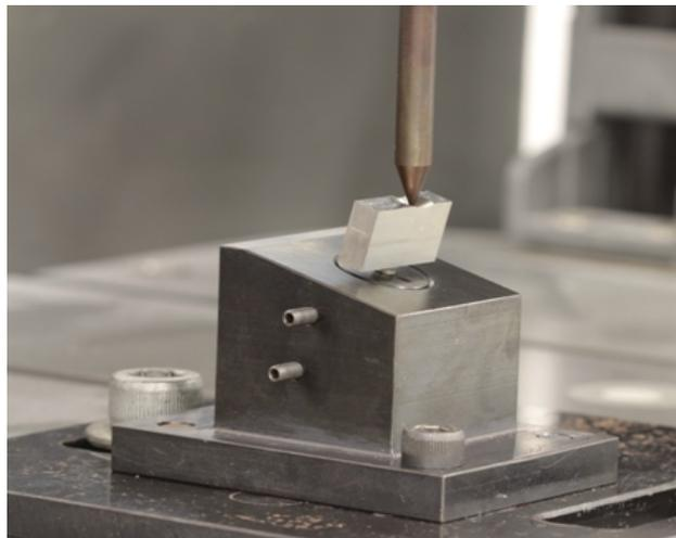
Fig 6: Conjunto com o corpo de prova sofrendo carregamento mecânico, com o ponto de carga 5 mm ao longo eixo do implante.
