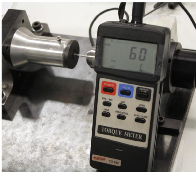
Figura1- Torquímetro digital utilizado na instalação dos implantes no bloco de poliacetal e na medição do destorque.
