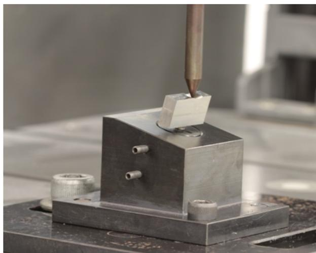
Figura 6- Conjunto com o corpo de prova sob carregamento mecânico, com o ponto de carga 5 mm ao longo eixo do implante.
