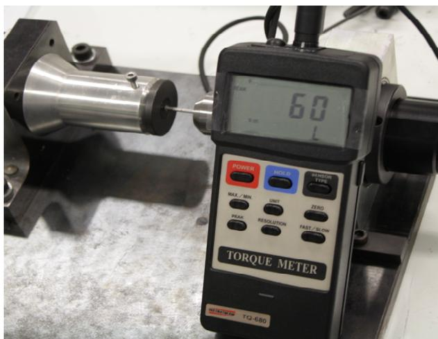
Fig 1: Aparato experimental utilizado na instalação dos implantes no bloco de poliacetal e na medição do destorque.
