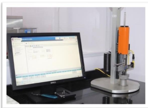
Figura 07: Máquina Multifuncional Torcional para leitura de liberdade rotacional.
