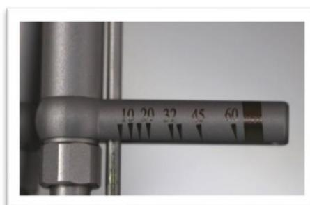
Figura 09: Marcações de valores de torques em Ncm, incluindo a marcação de 5 Ncm confeccionada.
