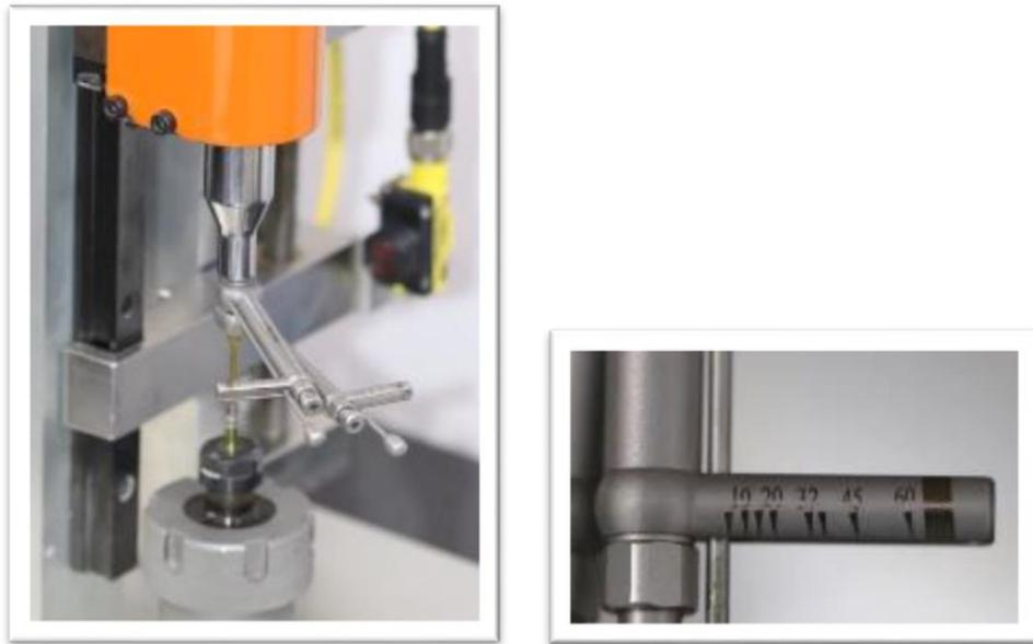
Figura 8 : Aproximação da adaptação de duas catracas torquímetro e marcação de 5 Ncm.
