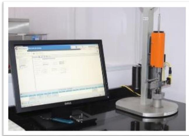
Figura 7: Máquina Torcional Multifuncional para análise de liberdade rotacional.
