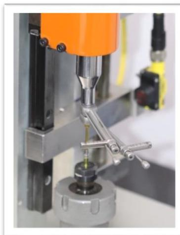
Figura 08: Adaptação de duas catracas torquímetro
