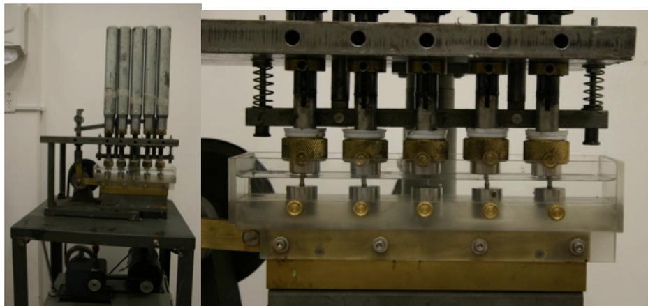
Figura 6 - Máquina de ensaios de simulação de mastigação, com os conjuntos implante/abutment na base, e os cilindros antagonistas acoplados às hastes de carga em sua porção superior.
