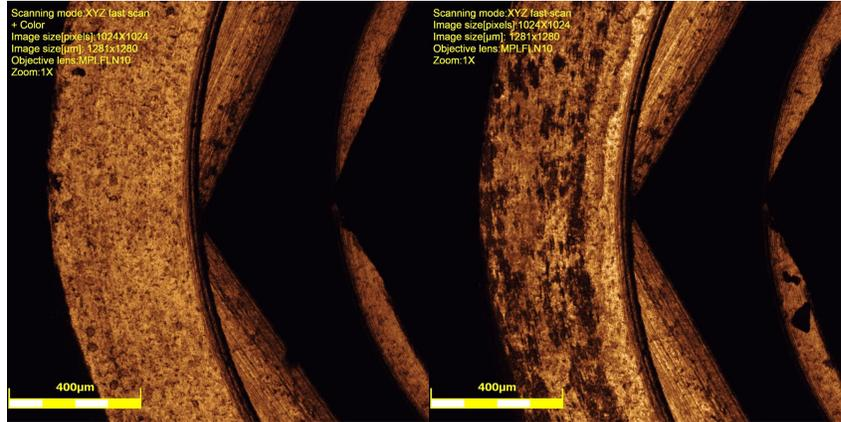
Figura 11 - Implante do G3 antes e após ensaio cíclico.
