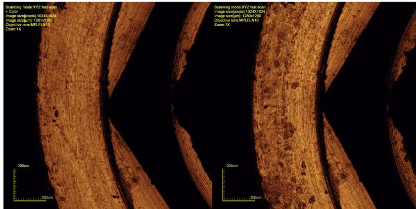
Figura 10 - Implante do G2 antes e após ensaio cíclico.
