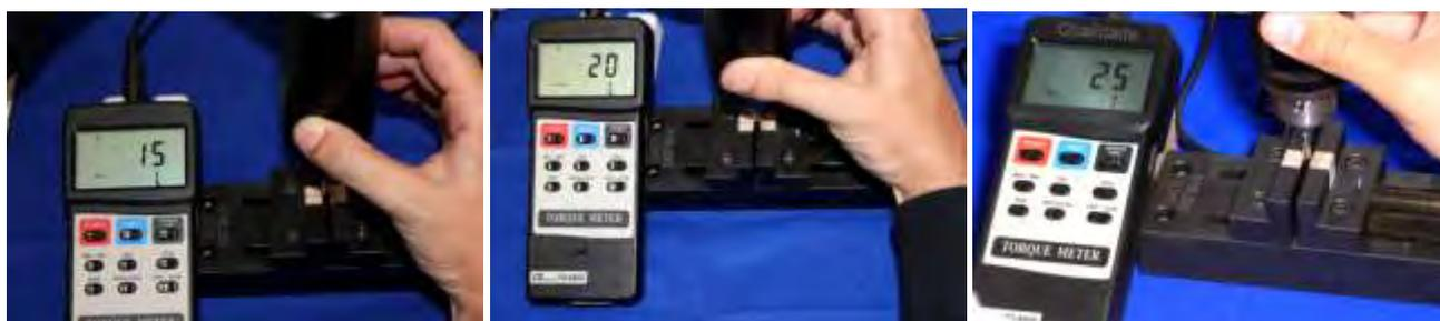
Figura 4- Visualização de 3 diferentes torques aplicados nos parafusos para cada grupo. A-G1 / B- G2 / C- G3.
