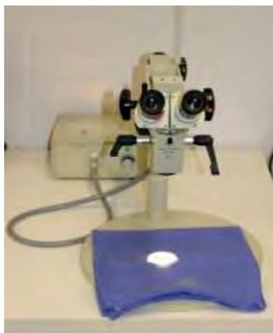
Figura 26- Microscópio óptico de 12.5 x de aumento.
