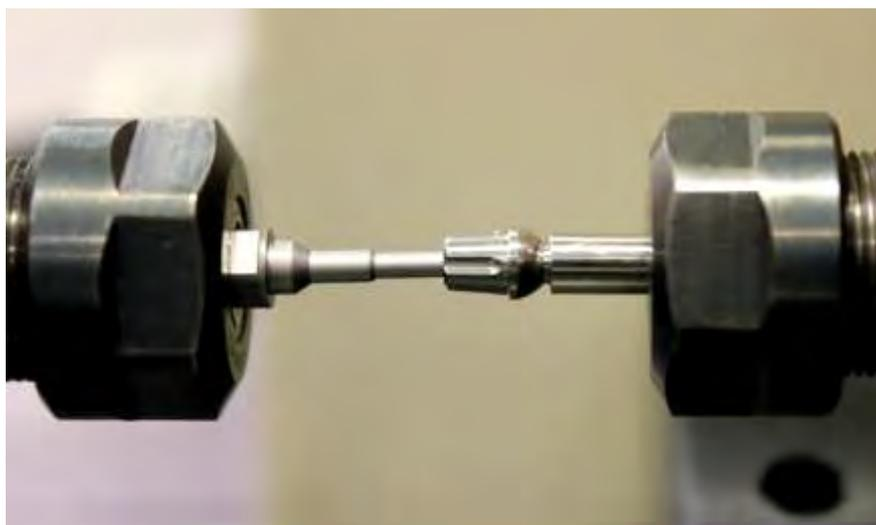
Figura 15- Notar a distância de segurança da base da chave hexagonal com o suporte de encaixe.
