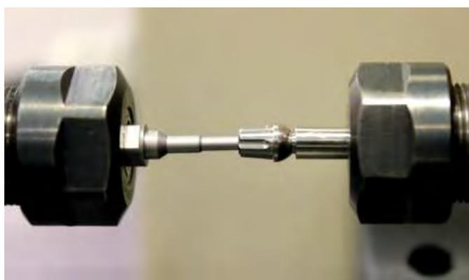
Figura 5- Chave 0.9mm encaixada no parafuso passante, e na parte do aparelho que realizará o destorque.
