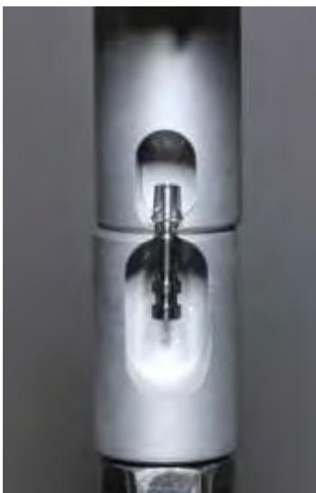
Figura 23- Corpo de prova posicionado na célula de carga.
