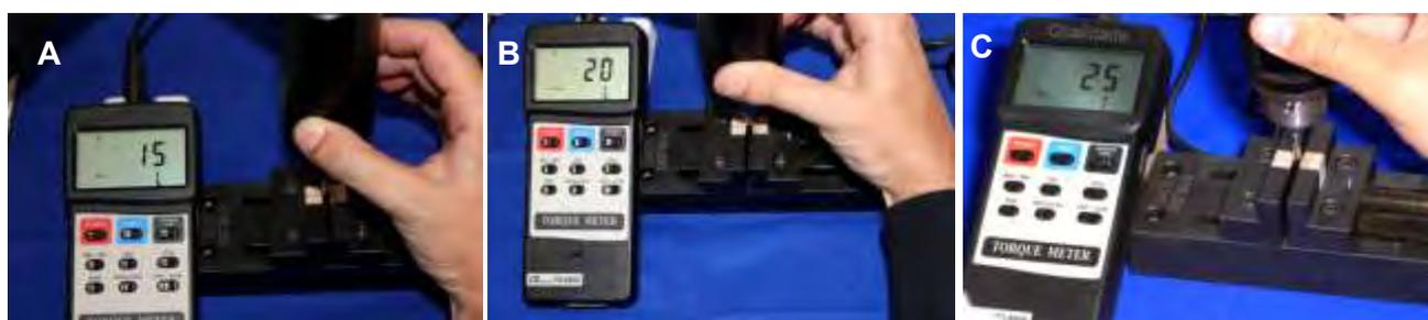
Figura 3- Visualização de 3 diferentes torques aplicados nos parafusos para cada grupo.
