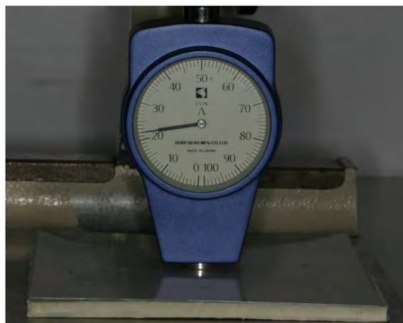
Figura 13 – Durômetro para verificação da homogeneidade da dureza da placa de Optocal de acordo com o *template* antes do corte.
