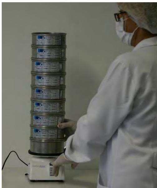
Figura 18 - Peneiras granulométricas com aberturas de 5,6; 4,0; 2,8; 2,0; 1,4; 1,0; 0,71 e 0,5mm – acopladas em ordem decrescente de abertura e posicionadas sobre um vibrador para facilitar a passagem do alimento.
