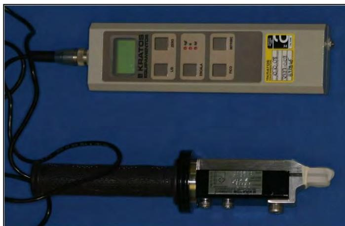
Figura 1 – Gnatodinamômetro utilizado para medir força máxima de mordida.
