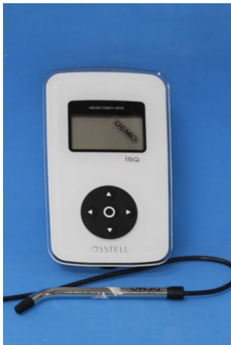
Figura 5- Aparelho de análise de frequência de ressonância.
