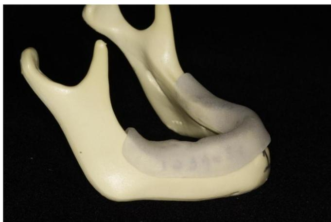
Figura 2- Guia de acrílico para orientação das perfurações nos corpos de prova.
