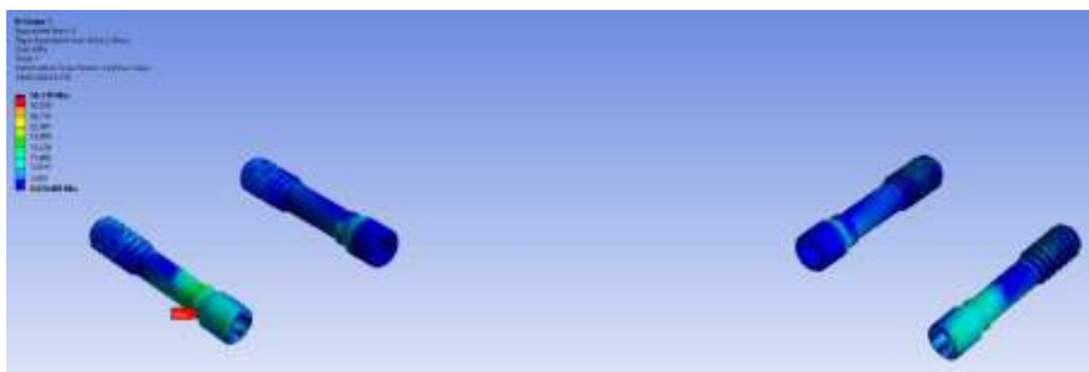
Figura 8- Distribuição das tensões de von Mises nos parafusos de fixação dos minipilares
