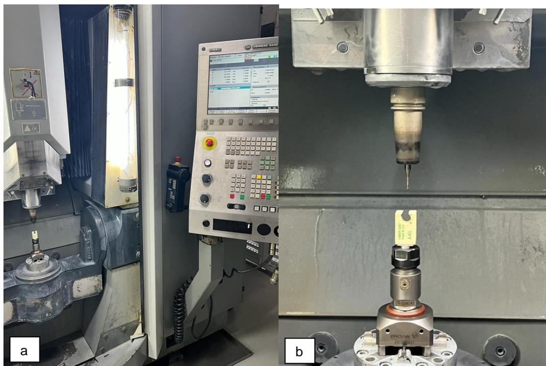
Figura 8 - a) Fresadora de 5 eixos DMG ultrassonic.
