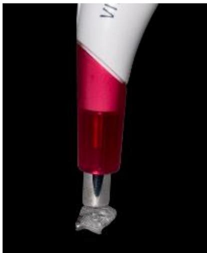
Fig.5- Posicionamento do espectrofotômetro VITA EasyShade Compact para leitura dos corpos de prova.
