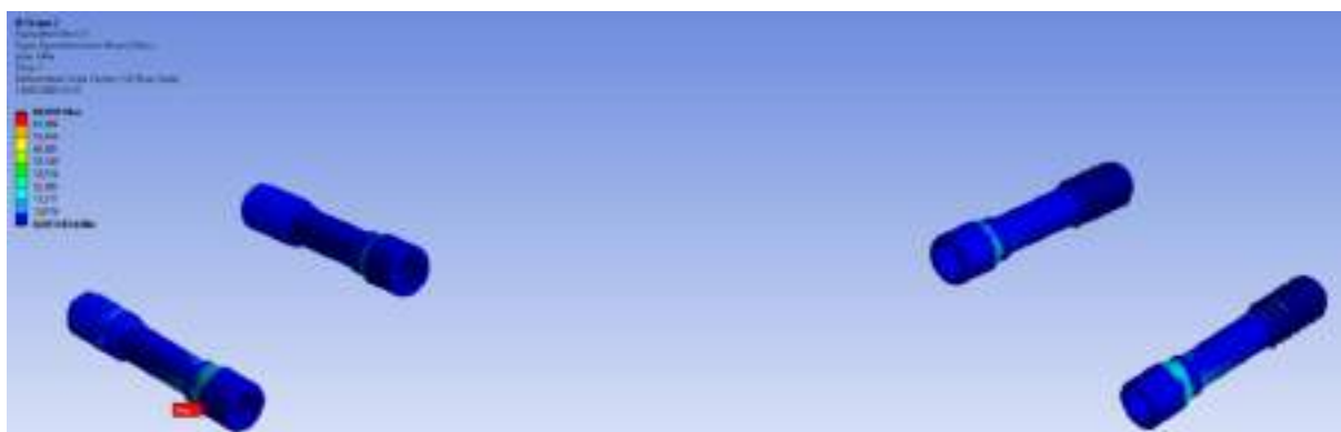
Figura 7- Distribuição das tensões de von Mises nos parafusos de fixação dos minipilares
