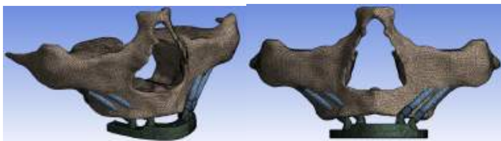
Figura 1- Modelo tridimensional de maxila reabilitada com 4 implantes zigomáticos subdividido em tetraedros para análise de elementos finitos com 903.778 elementos e 1.345.314 nós
